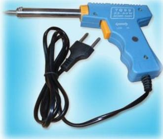
۸. بعضی از هویه ها نیز دارای کلیدی هستند که با فشردن آن کلید حرارت بیشتری برای لحیم کاری تولید می کند و در حالت عادی حرارت فقط برای گرم شدن هویه مناسب است که این کلید باعث صرفه جویی در مصرف برق می گردد . معمولاً هویه های مدل تفنگی این کلید را دارند .
