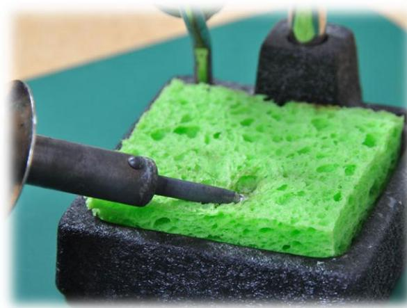
۳. بعد از این که نوک هویه به حرارت ذوب لحیم رسید ، نوک آن را به لحیم آغشته کنید تا با یک لایه نازک از لحیم پوشیده شود . این عمل از اکسید شدن نوک هویه جلوگیری می کند .
