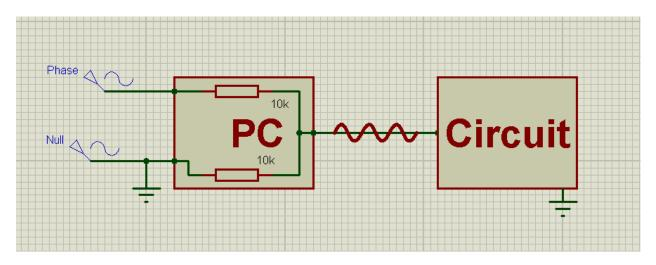
قبل از اتصال دو مدار الكتريكى نكته بسيار مهمى هست كه گاهى كاربران مبتدى از آن قافل هستند ايزوله بودن آن هاست.
